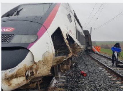
INGENHEIM TGV 1 SEMAINE SUITE À AFFAISSEMENT DE TALUS EN 2019
